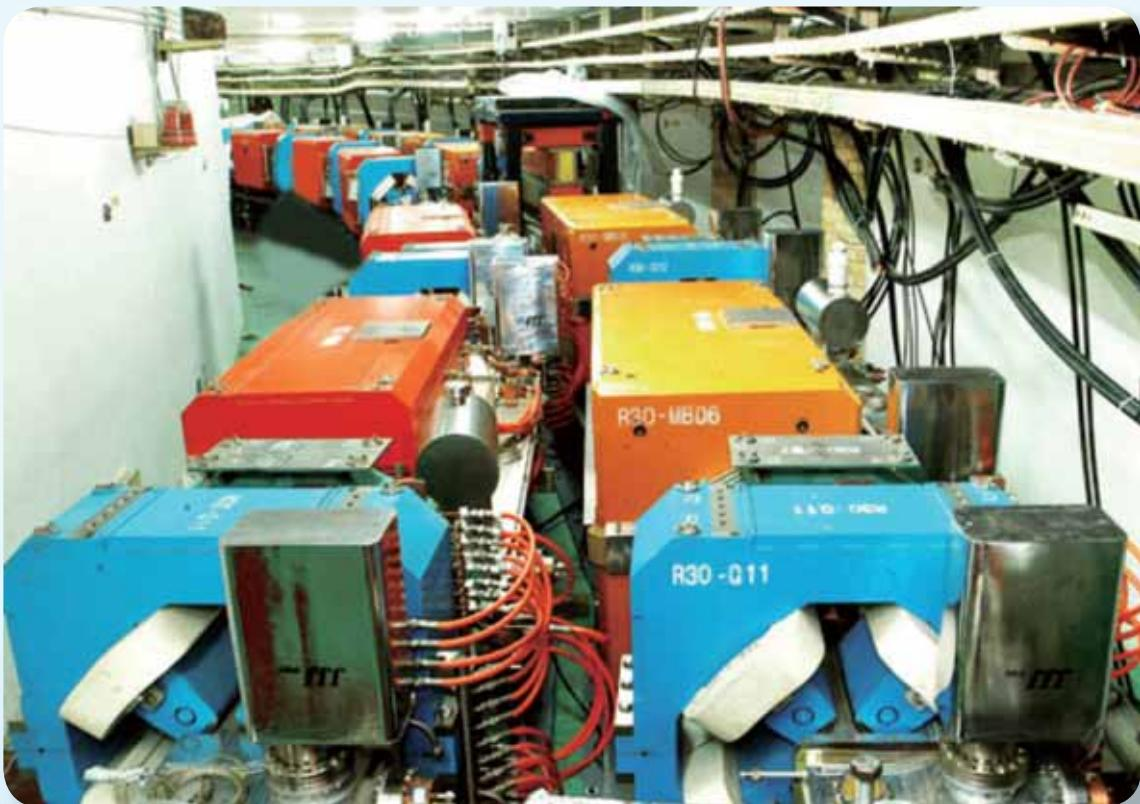
北京正负电子对撞机（BEPC）是世界八大高能加速器中心之一，是我国第一台高能加速器，也是高能物理研究的重大科技基础设施，由长 202 米的直线加速器、输运线、周长 240 米的圆型加速器（也称储存环）、高 6 米重 500 吨的北京谱仪和围绕储存环的同步辐射实验装置等几部分组成。北京正负电子对撞机是当时世界上唯一在  $\tau$  轻子和粲粒子产生阈附近研究  $\tau$ -粲物理的大型正负电子对撞实验装置，也是该能区迄今为止亮度最高的对撞机。
